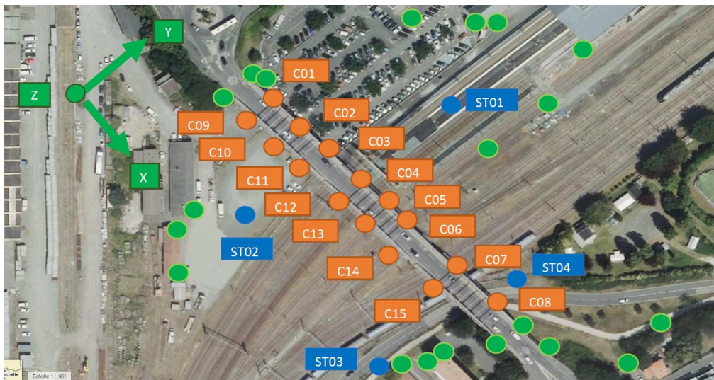
Figure 2 : Positionnement des cibles et des points de références
